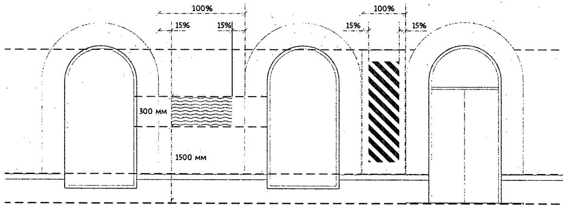
Кріплення до поверхні простінку має бути з відступом від усіх прилеглих архітектурних елементів не менше ніж 15% від ширини простінка, на якому розміщено конструкцію. При цьому товщина конструкції повинна відповідати вимогам, визначеним у п. 6.7 цих Принципів.
